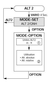
Pour passer du mode OPTION au mode RUN, il faut soit attendre 15 secondes soit presser simultanément sur les touches du clavier marquées OPTION.
