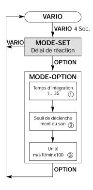
Le deuxième menu permet de choisir le **seuil de déclenchement de la tonalité**. Ce seuil de déclenchement peut être réglé entre + 2 cm/s et + 40 cm/s. Le seuil de déclenchement qui est en vigueur apparaît dans l'affichage linéarisé et correspond à un dixième de la valeur affichée. Ainsi, 2 m/s correspondent à un seuil de déclenchement de 20 cm/s.
